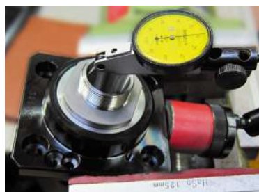
Inspection de l'extr mit  de sortie
