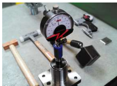
Inspection de l'extr mit  d'entr e
